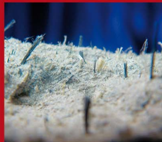
λ Fractura de fibrocemento.(placa de uralita) Fibras amianto Azules: crocidolita, blancas: crisolito
