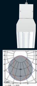
OD-5351 Reflector de aluminio especular de haz intensivo. Su utilización es recomendada en aplicaciones como hipermercados con alturas de hasta 7 m con una total uniformidad de luz sobre los distintos planos de trabajo. Instalación sobre portarreflectores OD-5350
