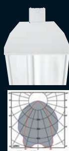
OD-5041 Reflector de aluminio especular de haz intensivo. Su utilización es recomendada en aplicaciones como hipermercados con alturas comprendidas entre 4,5 y 7 m con una total uniformidad de luz sobre los distintos planos de trabajo. Instalación sobre portarreflectores OD-5020
