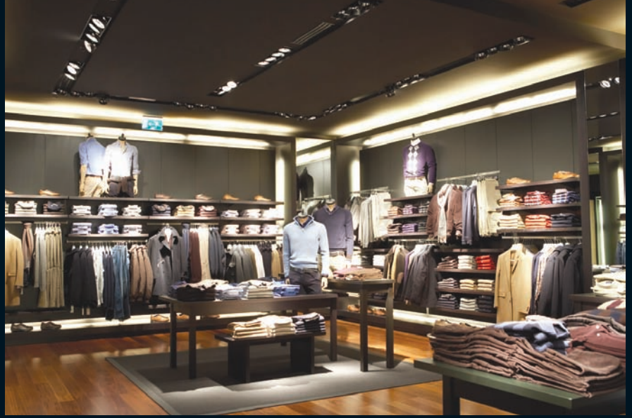
Íntima: Bajos niveles de iluminación en las áreas de tránsito con zonas más iluminadas en el perímetro.
