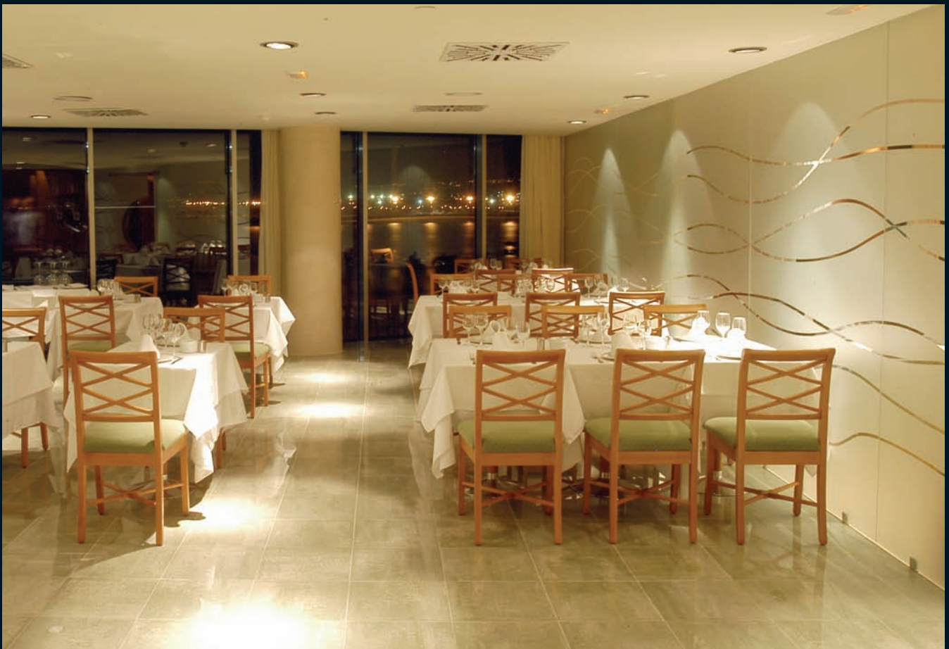
Relajada: Distribución asimétrica de las luminarias con algo de iluminación perimetral incidiendo sobre las paredes.
