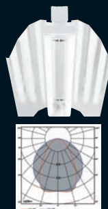
OD-5071 Reflector de aluminio especular de haz intensivo. Su utilización es recomendada en aplicaciones como almacenes con alturas comprendidas entre 5 y 10 m con una total uniformidad de luz sobre nuestras estanterías
