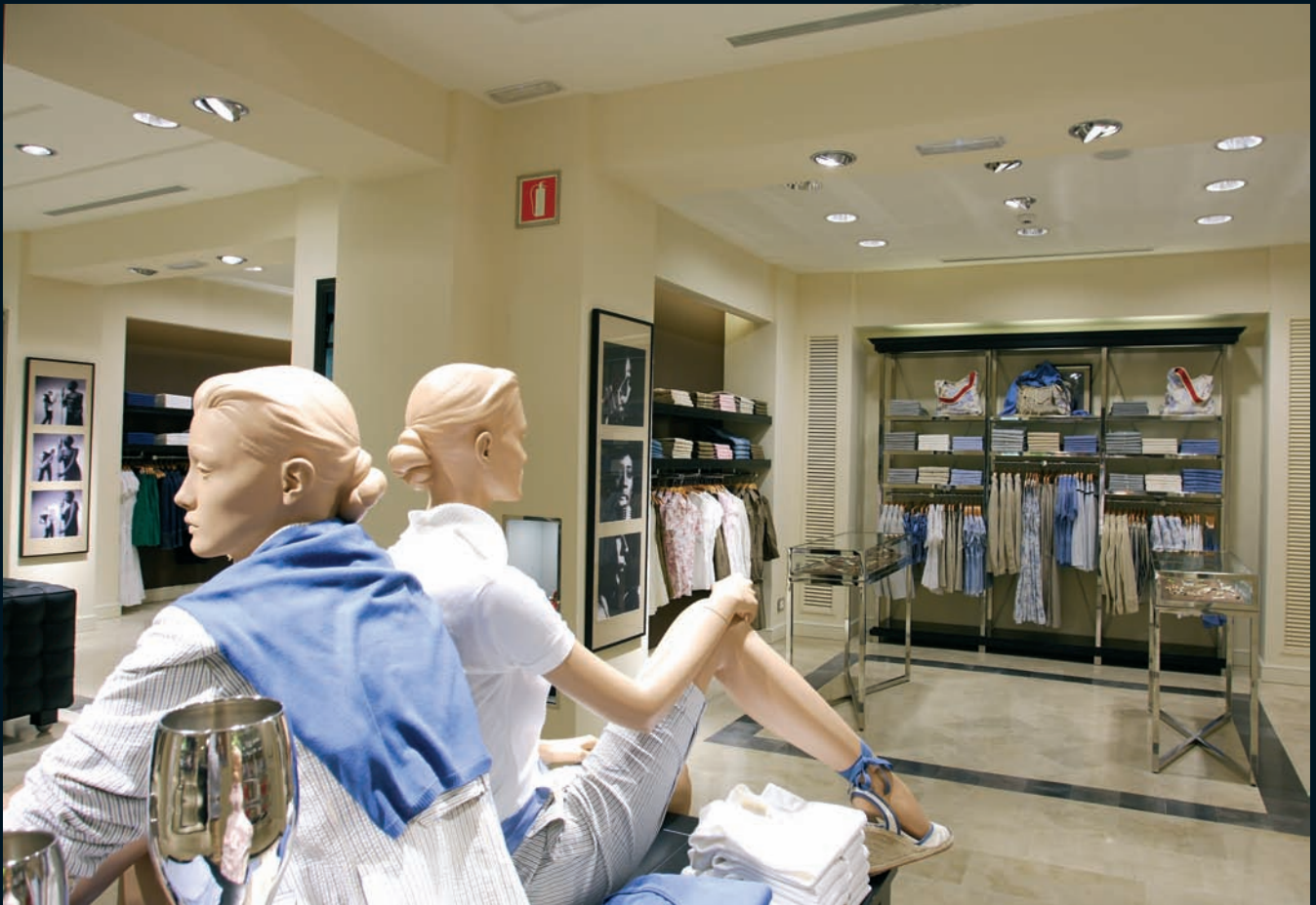
Espaciosa: Distribución simétrica de las luminarias con iluminación puntual perimetral.
