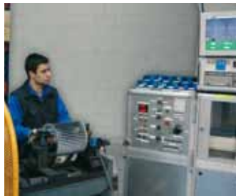
Equilibrado y montaje en la planta de Castellar del Vallès, Barcelona.
