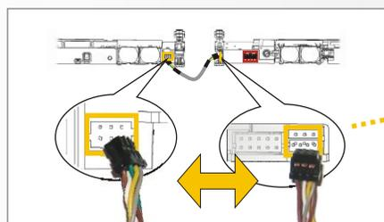
El CABLE SLAVE puede estar conectado con el módulo a la derecha o a la izquierda.
