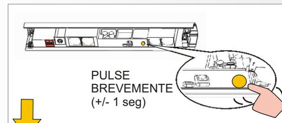
Pulse brevemente el botón de arranque del **MASTER** para lanzar un setup de todos los módulos.
