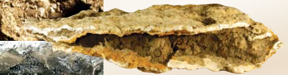
Muestra de suelo limoarcilloso tratado con resina Urettek®
