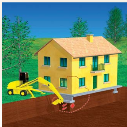
Descompresión o deslizamiento de suelo después de unos trabajos de excavación.
