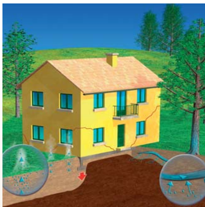
Sequedad de las capas superficiales del terreno debida a sequía o a la presencia de plantas con raíces profundas.
