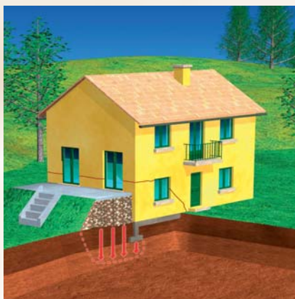
Sobrecarga concentrada en una porción del edificio.
