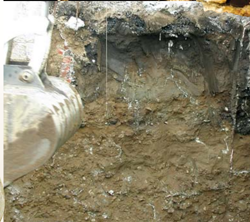
Muestra de suelo limoarcilloso tratado con resina Urettek®
