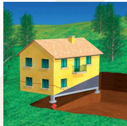
Diferencia de anclaje (ausencia de rediente en un terreno inclinado).
