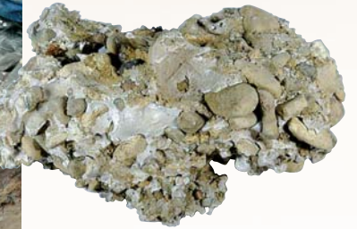
Muestra de suelo de arena gruesa tratado con resina Urettek®
