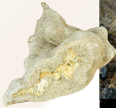
Muestra de arena tratada con resina Urettek®
