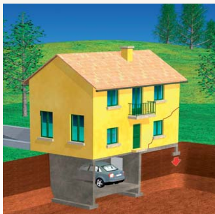
Diferencias en las dimensiones y profundidad de la cimentación en diversas áreas del edificio.
