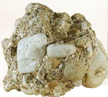
Muestra de suelo de arena gruesa tratado con resina Urettek®
