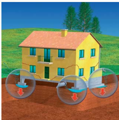
Exceso de agua causado por diversos factores: escorrentía, rotura de tuberías, empalmes defectuosos de aguas pluviales etc.
