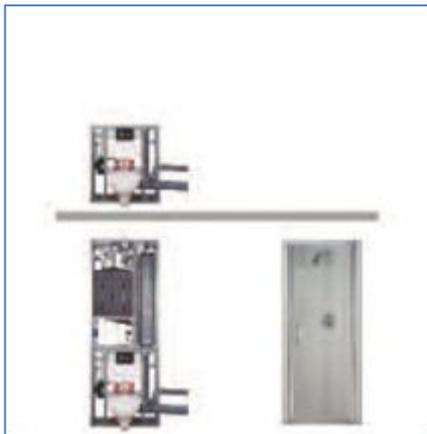
Sistema ECOPLAY para 2 WC . Modulo principal instalado en planta baja y modulo para 2º WC instalado en planta superior. El modulo principal recibe el agua procedente del plato de ducha o bañera gracias a la bomba externa de inyección ref. EC0001 (no indicada en la ilustración). Una vez almacenada y tratada el agua en el modulo principal, éste envía el agua tratada al segundo modulo gracias a la bomba de impulsión interna que incorpora la unidad principal.
