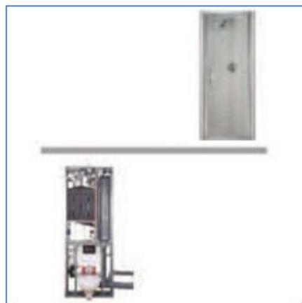
Sistema ECOPLAY para 1 WC instalado en planta baja y plato de ducha o bañera en la planta superior. En este caso no se precisa bomba externa de inyección ya que por gravedad, alimen
