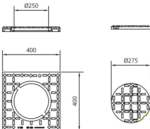
Realizadas en fundición dúctil. Cumplen con las prescripciones de la norma EN-124.
