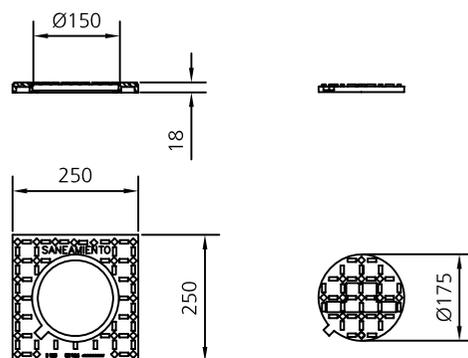
Realizadas en fundición dúctil. Cumplen con las prescripciones de la norma EN-124.
