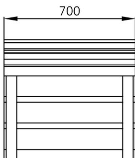
**MATERIAL:** Pies de fundición dúctil. Seis tablonces de sección 110 x 35 mm de madera tropical. Tornillos de acero inoxidable.
