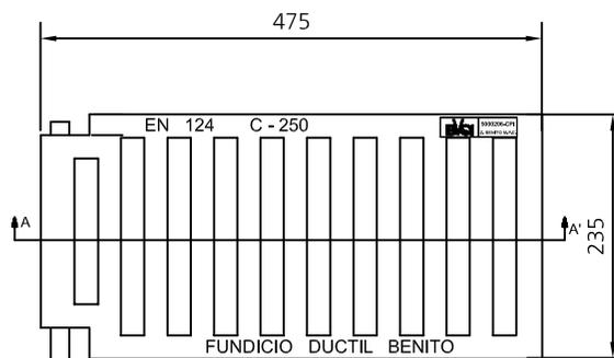
Realizada en fundición dúctil. Cumple con las prescripciones de la norma EN-124.
