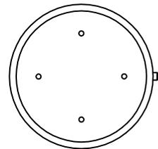
MATERIAL: Cubeta en plancha de acero galvanizado, con agujeros de Ø5 mm. Provista de un aro para fijar la bolsa.
