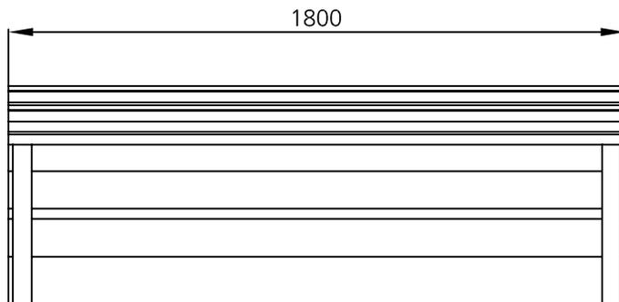
**MATERIAL:** Pies de fundición dúctil. Seis tablonces de sección 110 x 35 mm de madera tropical. Tornillos de acero inoxidable.
