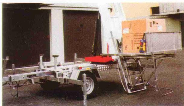
Los tres paneles laterales de la plataforma son desmontables y se pueden colocar en horizontal o en vertical. Dimensiones de la plataforma: cerrada mm 1230x830; abierta mm 1990x1210; paneles laterales 380 mm altura. La plataforma giratoria entra en la ventana o balcón para facilitar las maniobras de carga y descarga.
