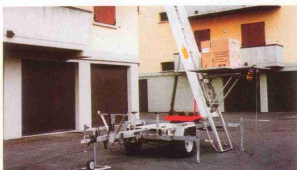
La fabricación de los elementos telescópicos con una aleación especial de aluminio de una elevadísima resistencia, permite elevar una carga útil de 200 kg. Todas las operaciones son eléctricas mandadas desde una botonera. El operario del piso superior dispone de una botonera (subida, bajada y paro de emergencia.)
