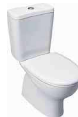
31180 Inodoro de 64 x 35 cm. salida horizontal. con juego anclaje. 31540 Tanque bajo con tapa y mecanismo de doble pulsador. Alimentación inferior izquierda.
