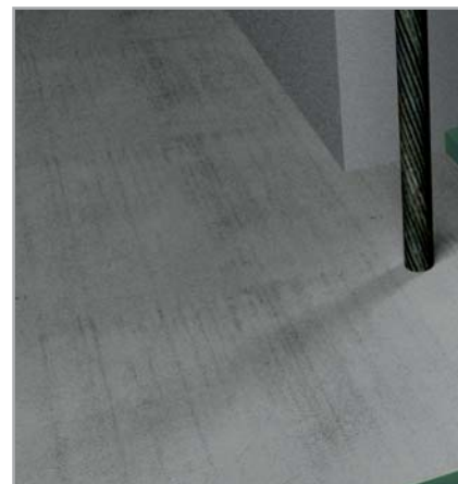
Fig. 7.41 - Accostamento tra IDROSTOP B25 impiegato per sigillare la ripresa di getto tra platea e parete e quello impiegato per le riprese di getto tra pareti contigue
