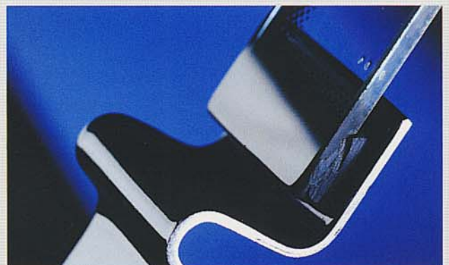
Unión pegada: Tensiones repartidas uniformemente.
