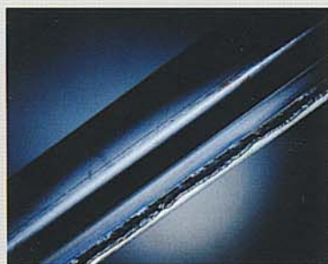
Unión soldada: Distribución irregular de esfuerzos.
