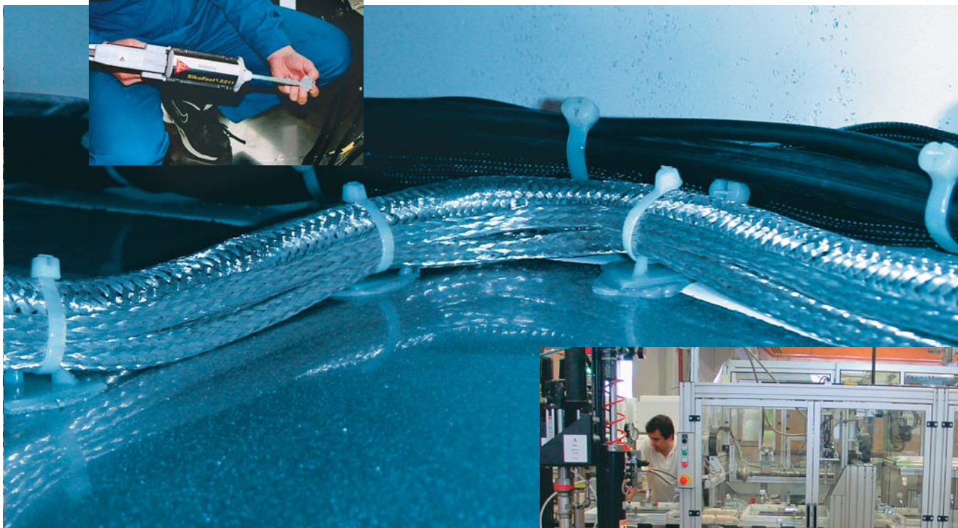
Integración de SikaFast® en una línea automatizada de producción usando una bomba y un sistema de dosificación.
