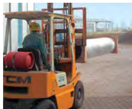
Las piezas de prolongación evitan que los rodillos se doblen.
