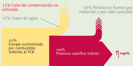
Rendimiento nominal de caldera convencional de alto rendimiento con temperatura de calefacción 75/60°C
