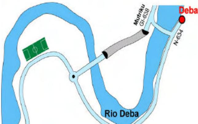
Se define una rotonda en la N-634 desde la que parte la nueva conexión a la carretera de Mutriku. El tramo comprendido entre la rotonda y el puente, se salva con un viaducto de 80 metros. A partir de este punto cruza la ría de Deba mediante un puente de 110 metros de luz y con dos arcos de 20 metros de altura, separados en la base y que se unen en el punto más alto. En la margen izquierda de la ría la carretera entra en un túnel de 304 metros de longitud que llega hasta la actual GI-638.
