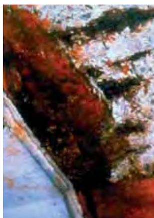
Ensayo de carbonatación sobre hormigón armado.
