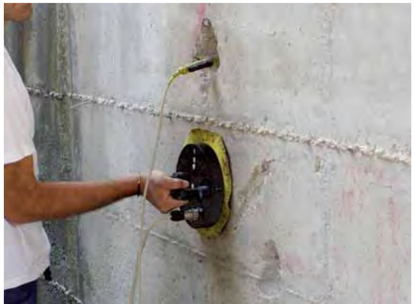
Medida de tasa de Corrosión empleando aparato GeCor 6.
