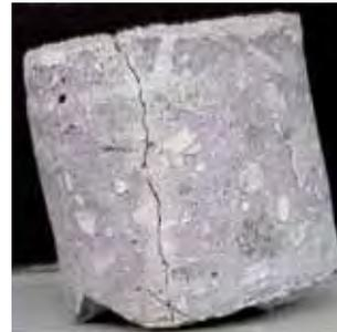
Una probeta extraída del tablero muestra micro fisuración. Un programa de ensayos extensivo (ver (fig.10) mostró la efectividad de este producto único incluso en el tablero de puente que exhibía gran cantidad de microfisuración.
