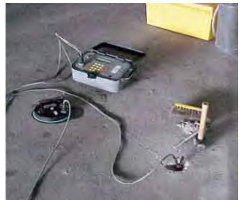
Medida de intensidad de corrosión empleando aparato GeCor 6.
