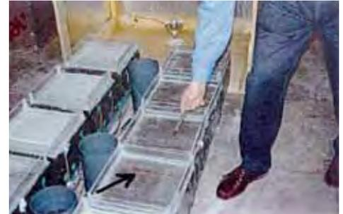
Cuando Protectosil® CIT se aplica antes de que las probetas sean sometidas a los ciclos de ensayo (equivalente a la aplicación de Protectosil® CIT sobre una estructura nueva) es **efectivo al 99% en la prevención de la corrosión**.
