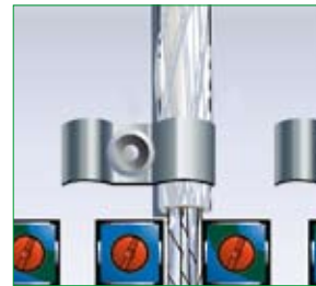
Sistema de sujeción de los cables de salida que asegura una buena continuidad de tierra del sistema
