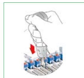
Regleta de conexión por desplazamiento de aislante. Conectar en EIA/TIA 568 B, mismo sistema que la toma
