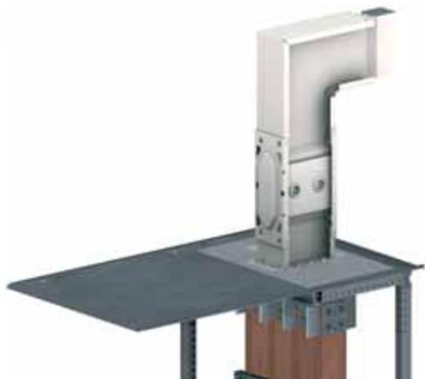
Canalis KT puede conectarse a los cuadros mediante una conexión tradicional. Para facilitar la instalación, se recomienda realizar el juego de barras del cuadro con un **entreeje = 115 mm**.
