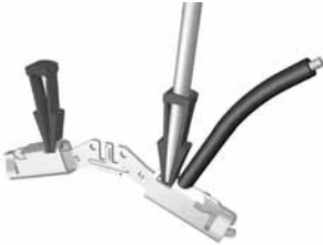
Principio de la tecnología desenchufable
